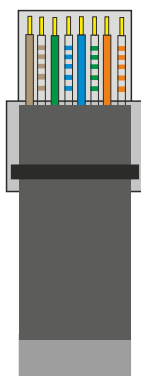
Рис. 4.2. Разводка проводов по стандарту EIA/TIA568B
